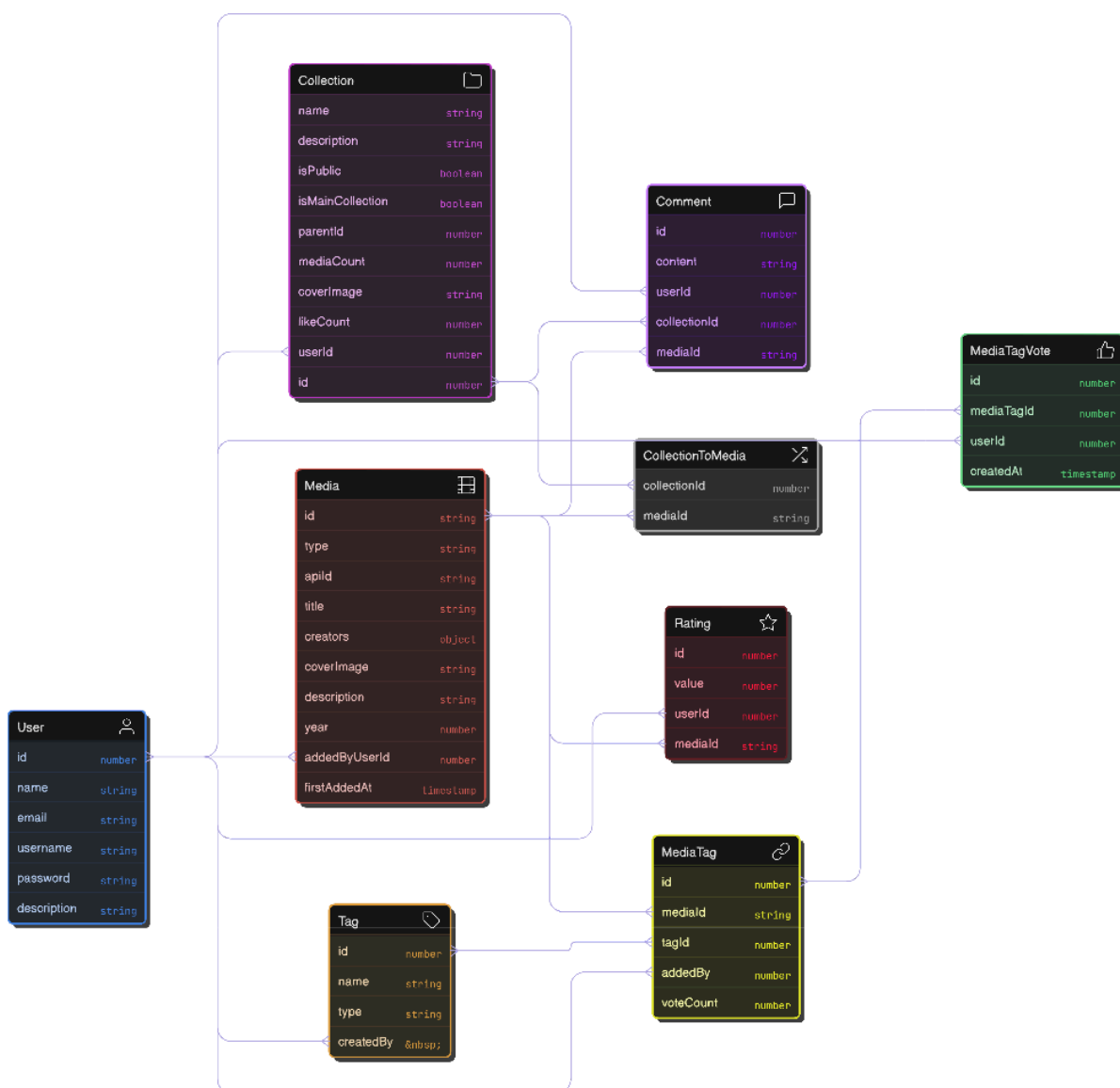
Rys. 4.2. Diagram ERD głównych encji systemu [opracowanie własne]
